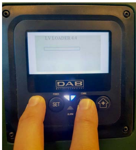
Figura 9D – Acceso al Loader para actualizar e.sybox mini3 Sw 1.X
