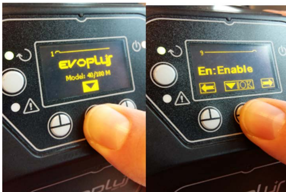
Afbeelding 10 - Softwareconfiguratie van de multifunctionele module
