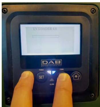
Рисунок 9С – Доступ к Loader для обновления e.sybox
