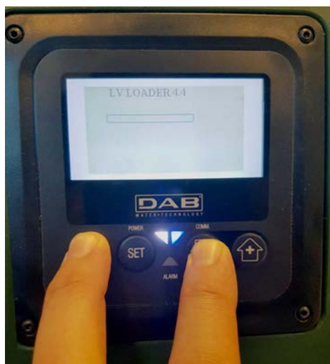
Obrázek 9D: Přístup k nahrávání aktualizace pro e.sybox mini3 Sw 1.X
