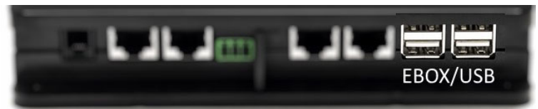
Image 6 - Connecteur USB dans le panneau EBox et dans le DConnect Box
