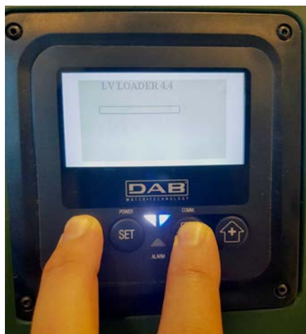
Figura 9C – Accesso al Loader per aggiornamento e.sybox
