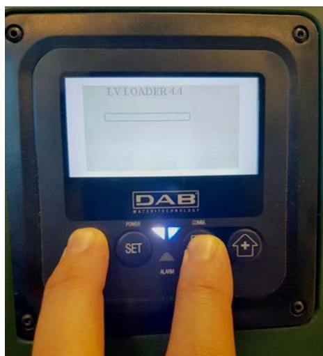
Afbeelding 9D – Toegang tot de Loader voor update van de e.sybox mini3 Sw 1.X
