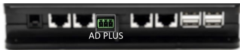
Figura 9A – Posizione connettore nel AD plus e nel DConnect Box, es. collegamento cavo dritto can-bus, nome connettore DConnect Box per collegamento con AD plus
