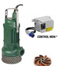
Bomba sumergible con cuerpo de la bomba, carcasa del motor y rodete de fundición. Disco de fricción de fundición revestido con caucho resistente a la abrasión. Eje del motor, asa, filtro y tornillería de acero inoxidable. Cierre mecánico de carburo de silicio, cámara de aceite inspeccionable.
