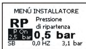
Рисунок 19: Настройка давления нового включения
