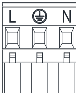
Slika 6: Snemljiva priključna sponka za priključitev napajanja
