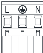
Figura 6: Morsettiere estraibile di alimentazione
