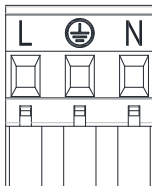
6 pav. Ištraukiama maitinimo gnybtų dėžutė
