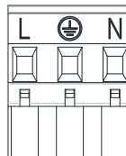
Obr. 6: Vyberateľná svorkovnica napájania
