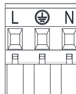
Сх. 6: Съёмная клеммная колодка электропитания
