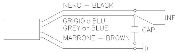
Figura 1: Schema di collegamento versione monofase Figure 1: Single-phase wiring diagram Figure 1: Schéma de connexion version monophasée Abbildung 1: Anschlussplan Wechselstromausführung
