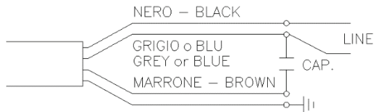
Figura 1: Schema di collegamento versione monofase Figure 1: Single-phase wiring diagram Figure 1: Schéma de connexion version monophasée Figura 1: Verbindungsschaltplan der einphasigen Version
