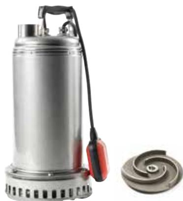
Cuerpo de la bomba, rodete, brida motor, filtro y disco, carcasa del motor, camisa exterior con asa y tapa del alojamiento de los cables de **acero inoxidable AISI 304**. Asa revestida de caucho aislante. Eje motor de **acero inoxidable AISI 316**.
