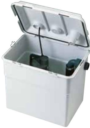
Estaciones automáticas de recogida y evacuación de aguas domésticas procedentes de bañeras, lavabos, duchas y lavadoras situadas en sótanos o por debajo del nivel de la red de alcantarillado. Equipadas con una electrobomba NOVA 300 con 5 metros de cable de alimentación y enchufe, instalada en un depósito de tecnopolímero con una capacidad de 30 litros y una válvula antirretorno instalada en la impulsión.
